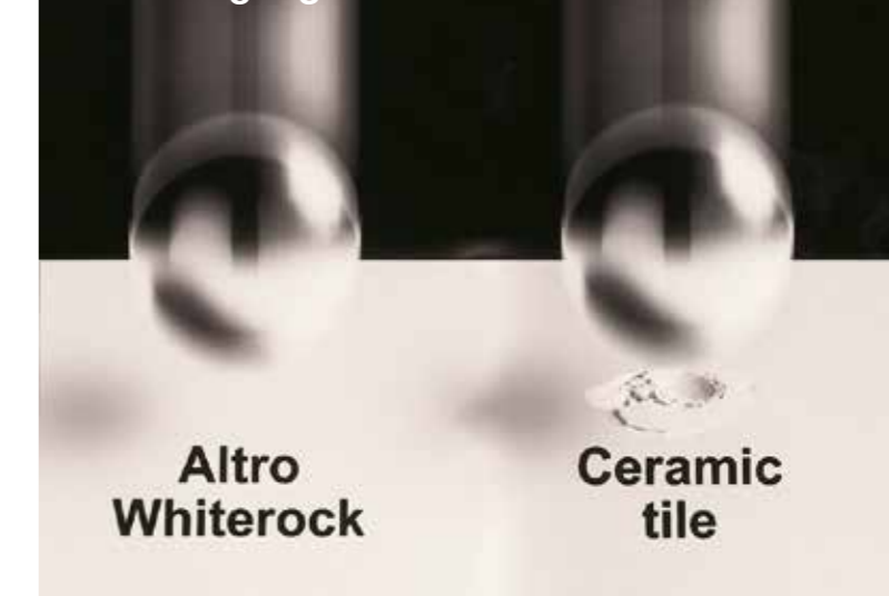
Beispielhafte Untersuchung der Schlagfestigkeit der Oberfläche nach EN 438-2 : 1991
